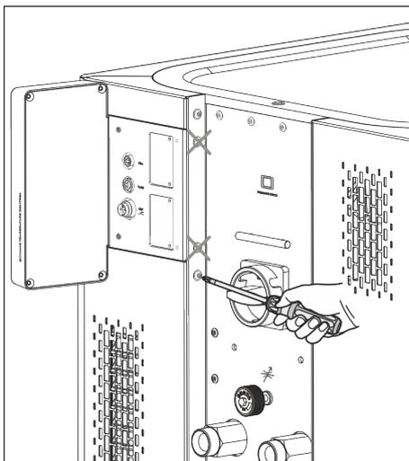
Abb. 81: Frontblech entfernen
