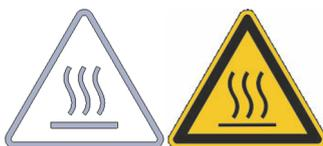
Auf dem Gerät ist das grafische Symbol "Heiße Oberfläche" aufgebracht. Mit diesem Symbol wird vor heißen Oberflächen des Geräts gewarnt. Diese Oberflächen dürfen im Betrieb nicht berührt werden. Um diese Oberflächen in anderen Lebensphasen zu berühren, wie beispielsweise bei der Instandhaltung, müssen diese auf Raumtemperatur abgekühlt werden.
