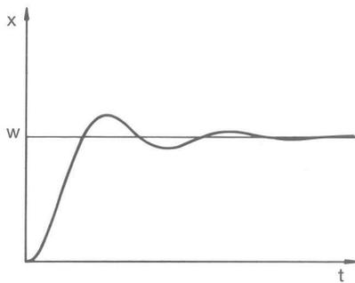
Abb. 68: Regelparameter  $T_n$  und  $T_v$  zu klein
