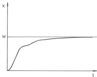
Abb. 69: Regelparameter  $T_n$  und  $T_v$  zu groß
