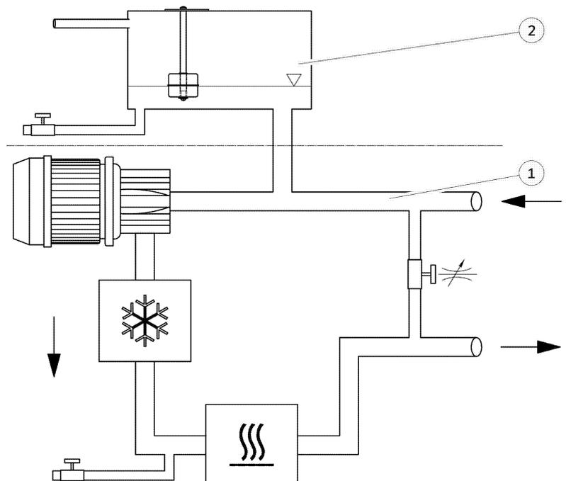
Abb. 6: Schema Hydraulikkreislauf
